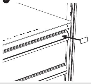
**OPTIONNEL :** installer la garniture en acier inoxydable avec DEL [122GZ02-0001] à l'aide des 3 vis autoforeuses.
